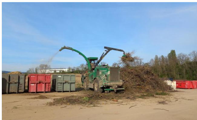
Intervention d'un broyeur forestier pour la transformation des branches
